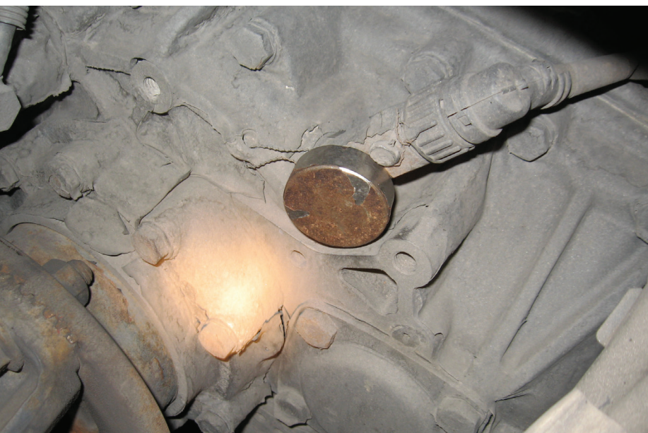
Magnes zakłócający pracę tachografu w pojeździe ciężarowym.
